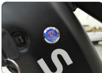
Bitte schalten Sie den Netzschalter nach der Fahrt aus. Es ist normal, dass es ein paar Sekunden dauert, bis das Licht ausgeschaltet ist.
