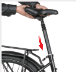
Inserte el tubo de asiento según la dirección y ajuste la altura
