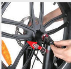
Instale las tuercas de cierre rápido en el lado opuesto de la pinza
