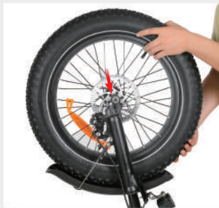
Inserire il pneumatico nella forcella
