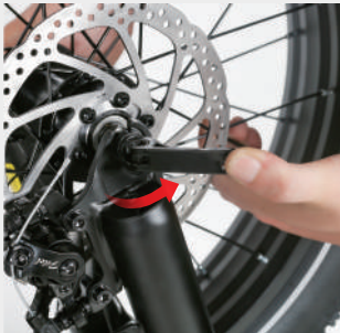
Premere saldamente il morsetto a sgancio rapido per garantire una salda tenuta.
