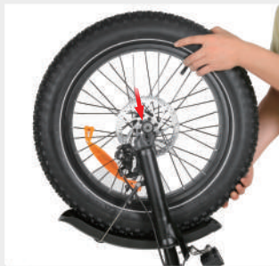
Placer le pneu dans la fourche
