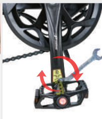
ziehen Sie das rechte Pedal mit der Markierung "R" im Uhrzeigersinn an.
