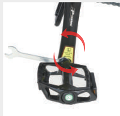
Apriete el pedal izquierdo marcado "L" en el sentido contrario a las agujas del reloj.
