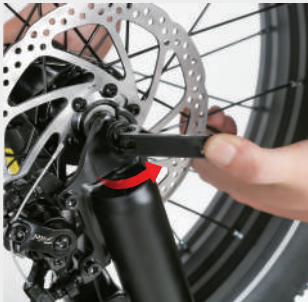
Presione firmemente la abrazadera de liberación rápida para garantizar la firmeza.
