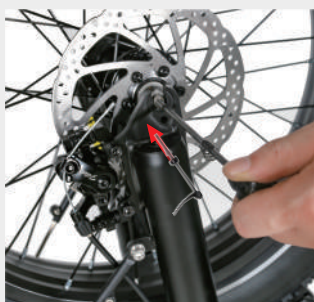
Inserire il morsetto a sgancio rapido nella fessura del morsetto della ruota anteriore
