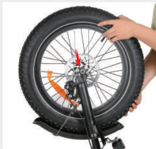
Poner el neumático en la horquilla
