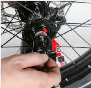
Apriete el desmontaje rápido en la dirección
