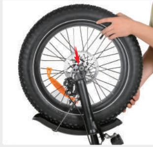
Setzen Sie den Reifen in die Gabel
