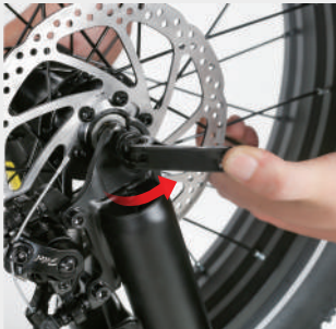
Serrer le démontage rapide dans le sens des aiguilles d'une montre.
