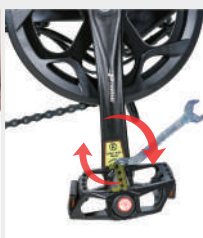
Serrer la pédale droite marquée "R" dans le sens des aiguilles d'une montre.
