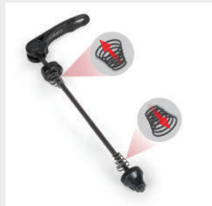
Retirer le collier de serrage rapide en faisant attention à la direction du ressort.
