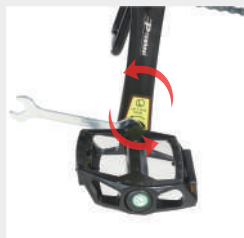
Serrer la pédale gauche marquée "L" dans le sens inverse des aiguilles d'une montre.
