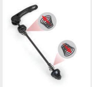
Die Schnellspannklemme herausnehmen und dabei auf die Richtung der Feder achten.
