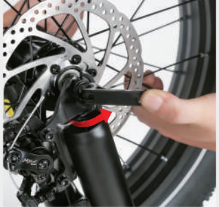
Drücken Sie die Schnellspannklemme fest, um einen festen Sitz zu gewährleisten.
