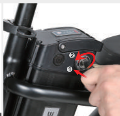
Appuyez fermement sur le trou de serrure dans le sens de la flèche 1 et tournez la clé dans le sens de la flèche 2 pour ouvrir le verrou de la batterie.
