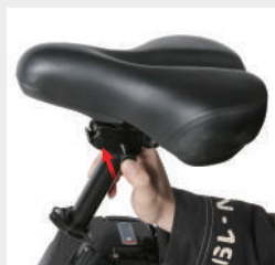
Appuyer fermement sur la boucle de la selle en respectant le sens.
