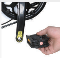
N'installez pas les pédales à l'envers, cela endommagerait le filetage.
